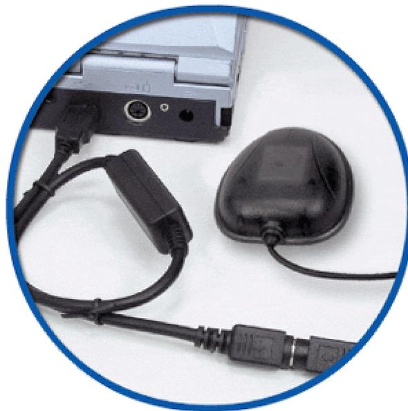
Le récepteur GPS HI204E est conçu pour se connecter à tous les PDA, Palm ou Pocket PC, via un câble propre à chaque modèle et permet de transformer votre PDA en un véritable système de navigation embarquée. Il est également compatible avec la majorité des logiciels de navigation.
